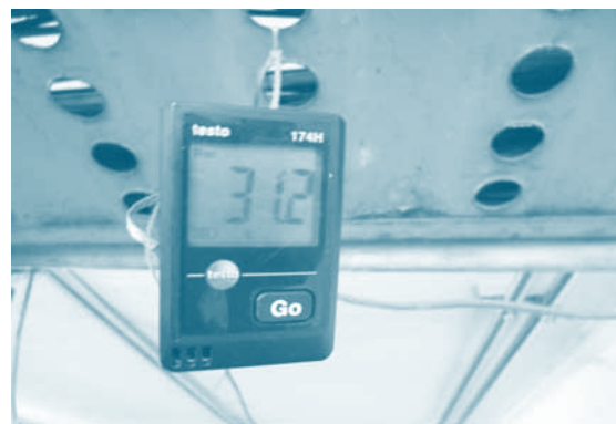
การตรวจวัดและเก็บบันทึกข้อมูลอุณหภูมิน้ำระบายความร้อน อุณหภูมิและความชื้นอากาศแวดล้อม
