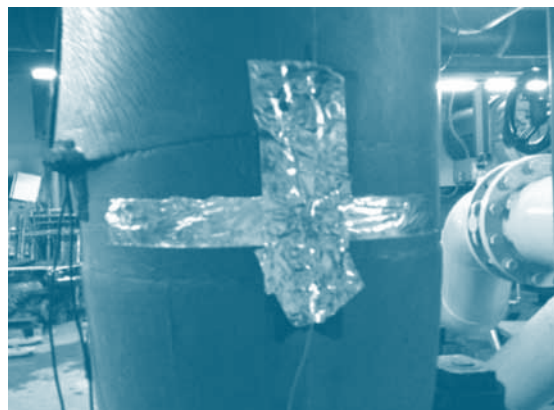
การติดตั้งเครื่องมือในการตรวจวัดและบันทึกค่าอุณหภูมิและความชื้นของอากาศ
