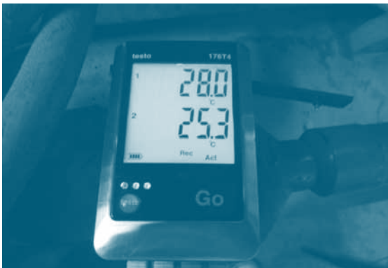
การตรวจวัดและเก็บบันทึกข้อมูลอุณหภูมิน้ำระบายความร้อน อุณหภูมิและความชื้นอากาศแวดล้อม
