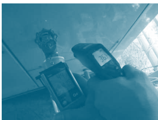
ตำแหน่งตรวจวัดกำลังไฟฟ้าและอุณหภูมิของระบบผลิตน้ำร้อนสำรอง
