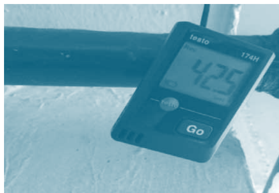
การติดตั้งเครื่องมือในการตรวจวัดและบันทึกค่าอุณหภูมิและความชื้นของอากาศ
