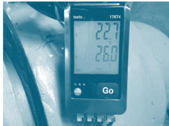
เครื่องมือที่ใช้ในการบันทึกข้อมูลอุณหภูมิของน้ำเย็นและน้ำระบายความร้อนที่คอนเดนเซอร์
