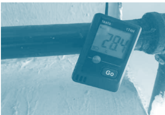
การติดตั้งเครื่องมือในการตรวจวัดและบันทึกค่าอุณหภูมิและความชื้นของอากาศ
