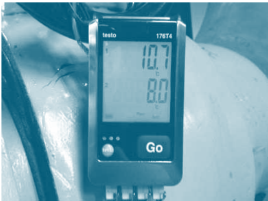
เครื่องมือที่ใช้ในการบันทึกข้อมูลอุณหภูมิของน้ำเย็นและน้ำระบายความร้อนที่คอนเดนเซอร์
